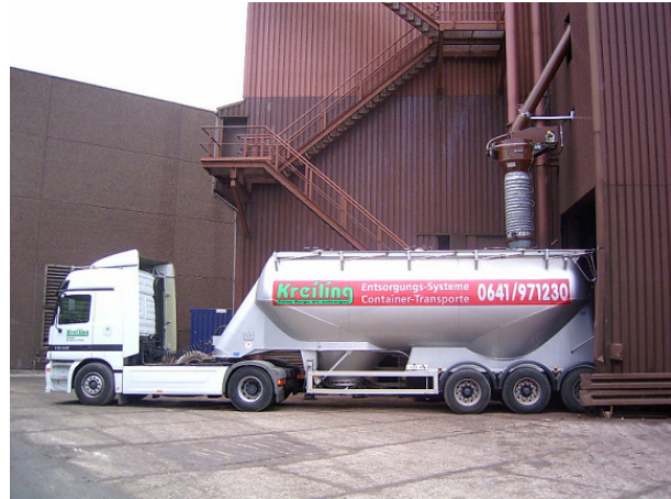
Bild 1: Staubverladesystem mit Silo-LKW
